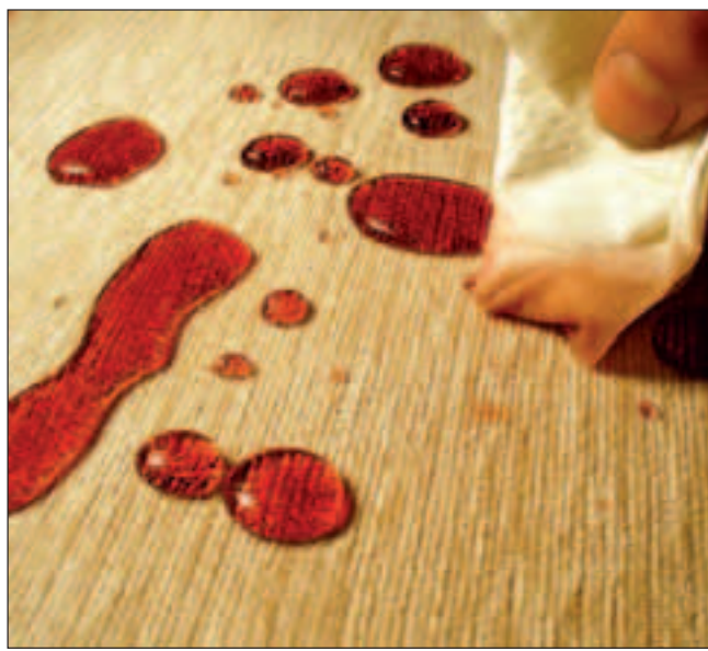
Il comportamento idrofobico di un tessuto con nanoparticelle
